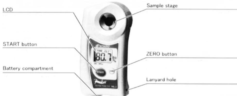
**LCD:** Se muestran los resultados de medición, temperatura del prisma y restante de carga de la batería. El valor mostrado es un ejemplo.
